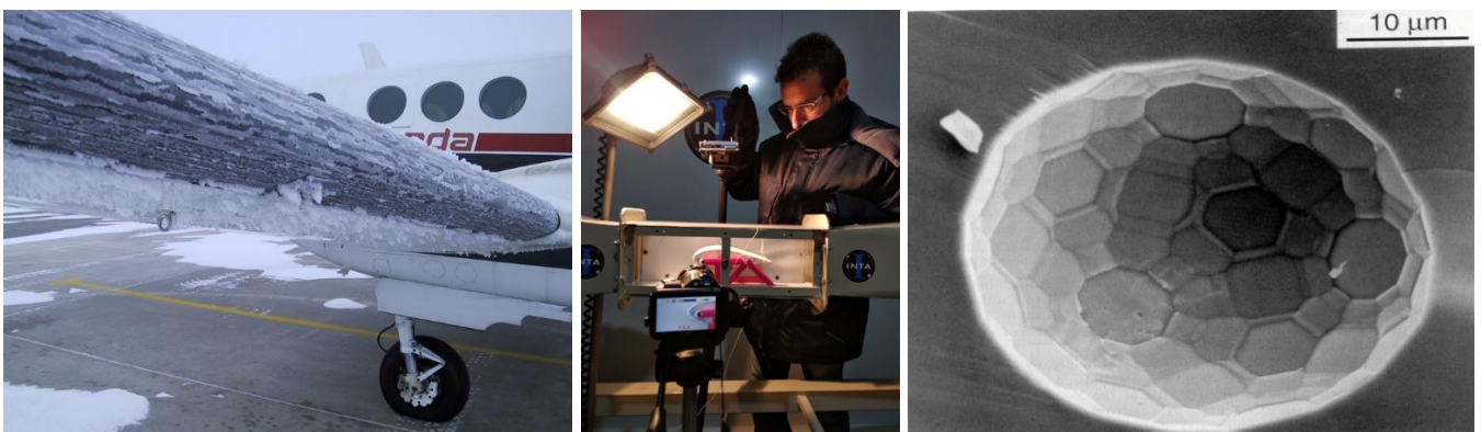
Izda: borde de ataque con formación de hielo. Centro: ensayos de formación de hielo en túnel de hielo de INTA. Dcha: imagen de microscopia electrónica de cuasicristal.
