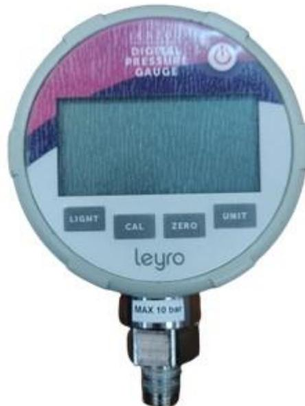
Imagen 1. Patrón viajero - Manómetro de presión relativa neumática leyro
