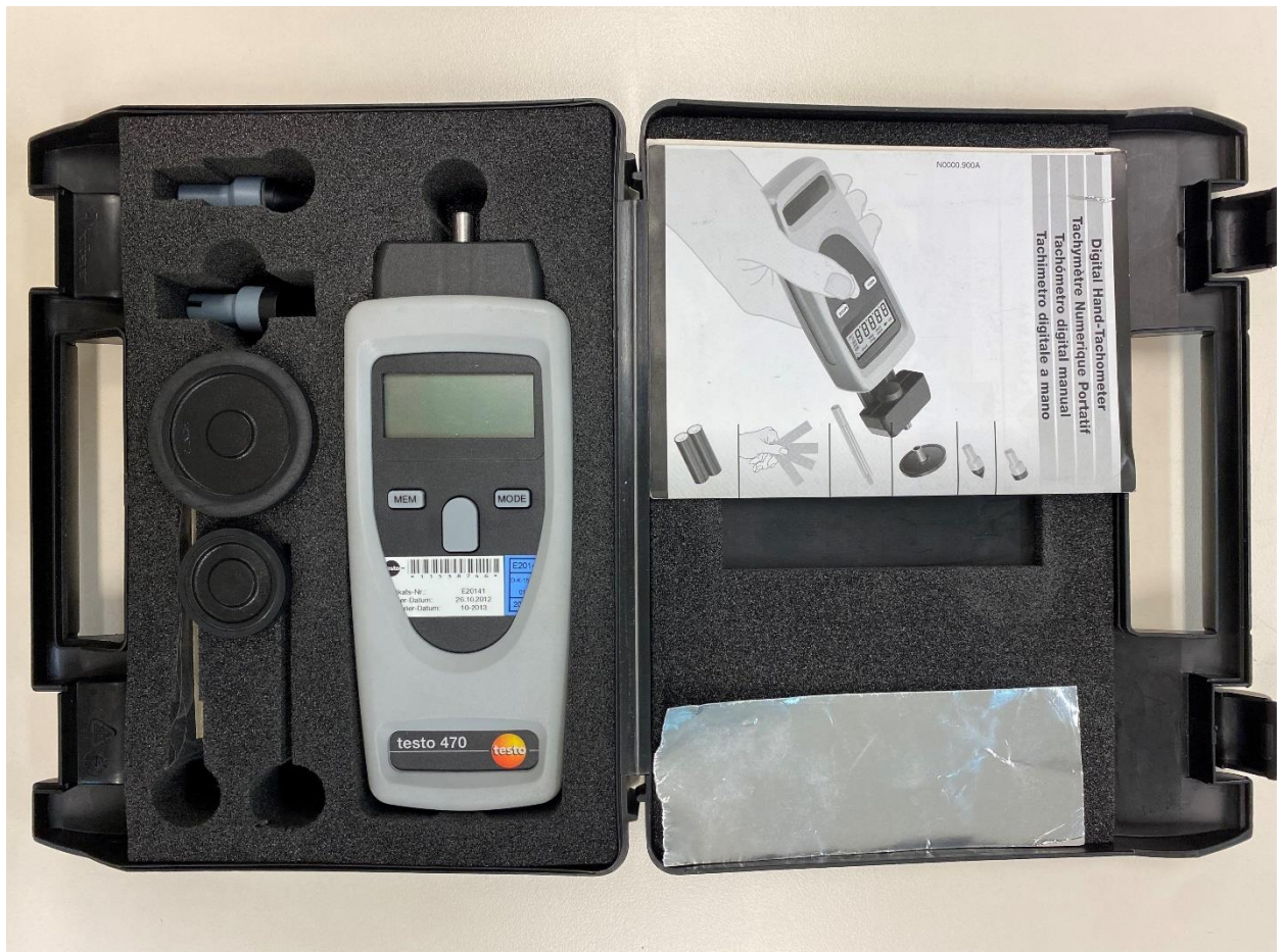
Imagen 1. Maletín de transporte con patrón viajero y elementos auxiliares.
