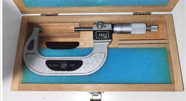
Imagen 2. Micrómetro de exteriores.
