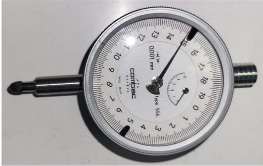
Imagen 1. Comparador de un palpador mecánico.
