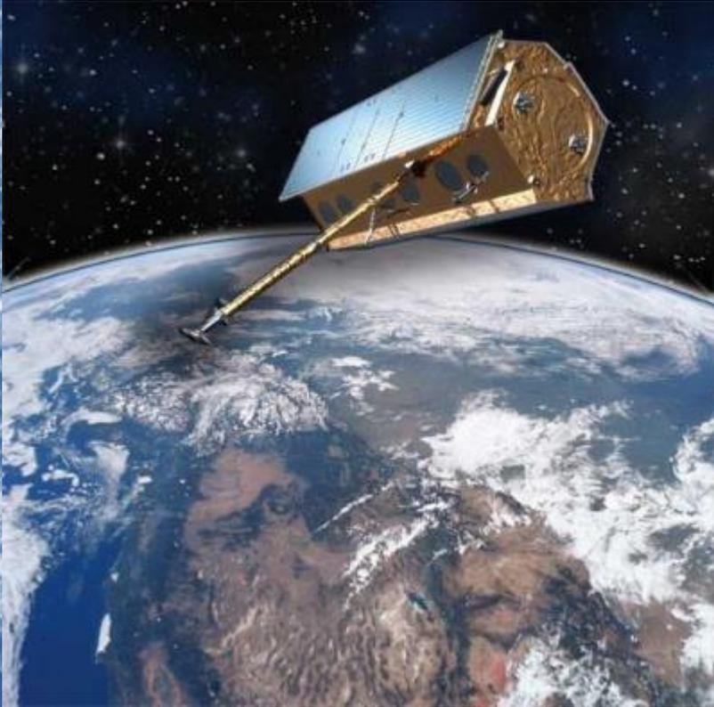
La plataforma de PAZ es recurrente de los satélites alemanes TerraSAR-X y TanDEM-X. El instrumento principal de la carga de pago de PAZ es un radar de apertura sintética (SAR), un sensor activo de microondas capaz de obtener imágenes de 1 metro de resolución a 500 km de distancia.
